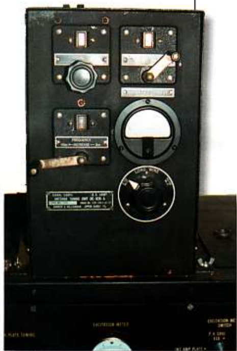
Antenne afstemmingseenheid type BC-939-A behorende bij de zender type BC-610
